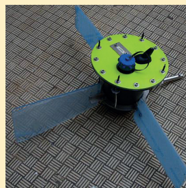
B ábra. Terepi méréseinkben használt GPS-es úszó bója
