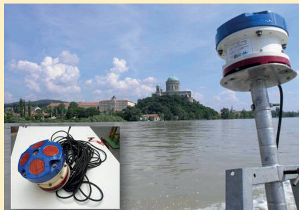
A ábra. Az ADCP műszer „bevetésre” várva a Dunán, illetve a laborban
