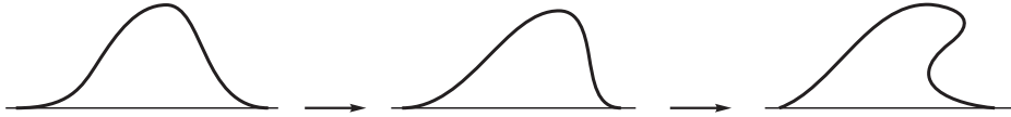
9.2 ábra: A hullámtörés mechanizmusa: a kezdeti egyszerű felületi kidudorodás aszimmetrikussá válik, s a hullámmaximum egy idő után megelőzi a hullám elejét. Ez az instabil állapot a hullám megtörését eredményezi. Az ábra három egymást követő időpontbeli állapotot mutat.
