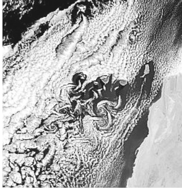
7.13 ábra: A Föld sugaránál jóval kisebb skálán a környezeti áramlások a kétdimenziós turbulencia jellegzetességeit mutatják: nagy örvények a Kanári-szigetek mögött a felhőkben kirajzolódó Kármán-féle örvénysorokban (2000. április 24.). A kép jobb oldalán Afrika nyugati partvonala látható [daac.gsfc.nasa.gov/CAMPAIGN_DOCS/OCDST/vanKarman_vortices.html].
