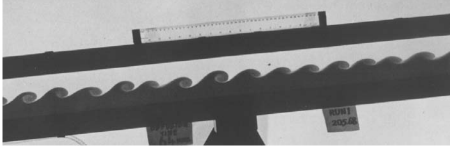
5.40 ábra: Kelvin–Helmholtz-instabilitás létrehozható egy kétrétegű folyadékot tartalmazó edény megdöntésével [Van Dyke].
