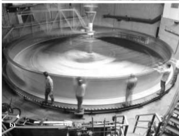
7. ábra. A Coriolis-platform. a) Kísélet előkészítése közben. b) Forgó állapotban (a kísérletet végzők a platformon dolgoznak) [www.coriolis-legi.com/coriolis-turnstile.htm].
