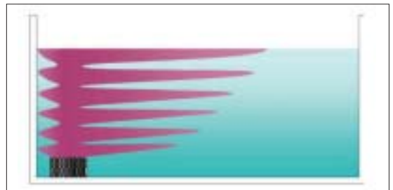
24. ábra: A jégtömb olvadásával járó áramlások vízszintes „nyelveket” formálnak
