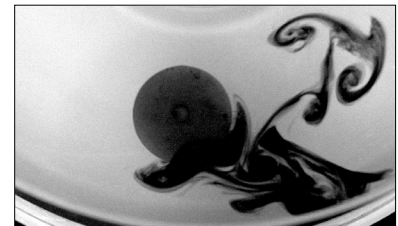
28. ábra: a) A forgatott, vízzel telt edény fenekén rögzített alacsony henger elé festéket fecskendezünk. b) A szétterjedő festék a 27. ábrának megfelelően függőleges felületek mentén oszlik szét a folyadék teljes mélységében (a felülnézeti képen ezért jelenik meg egy éles mintázat), de nem folyik rá a hengerre, hanem megkerüli a fölötte lévő vízoszlopot, a Taylor-oszlopot is
